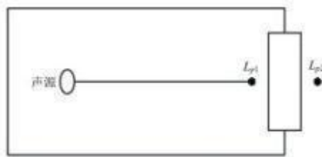
图 4-2 室内声源等效为室外声源图例
