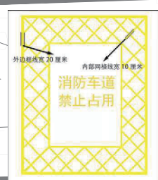
图2：消防车通道禁止占用警示牌示例
